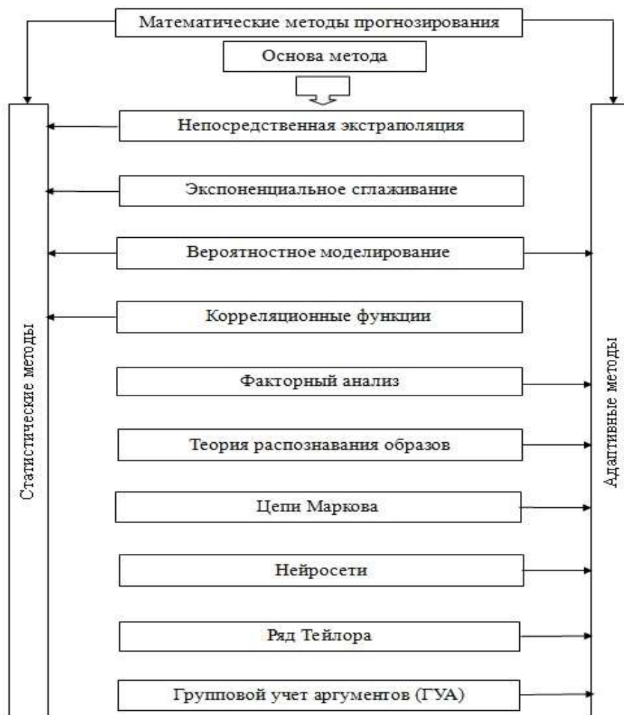
Рисунок – Схема классификации математических методов прогнозирования значений случайных процессов, которые могут быть использованы в шахтной метанометрии
