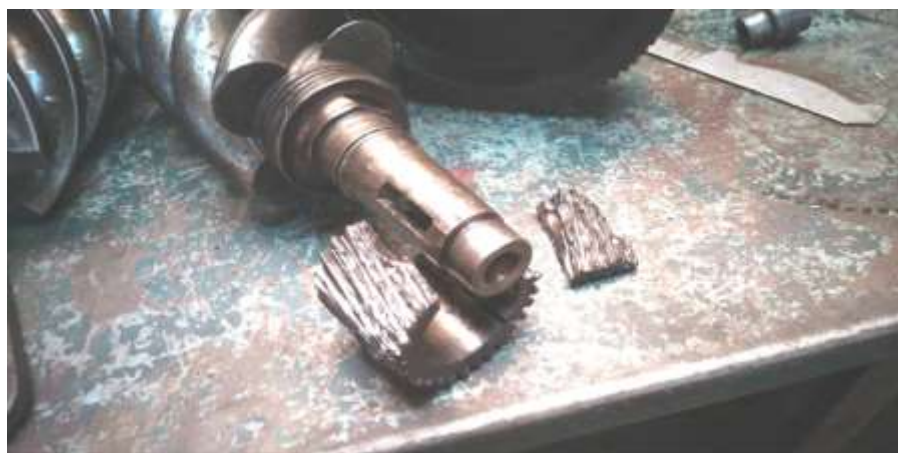
Рис. 1. Общий вид повреждений малой шестерни редуктора компрессорного блока ЗИФ-ШВ-5М
