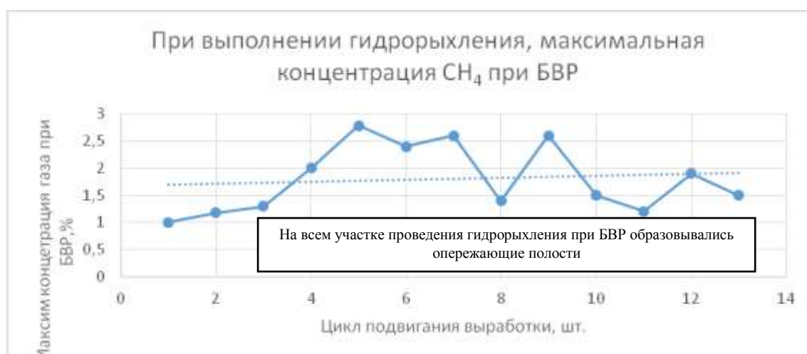
Рис. 9. Максимальная концентрация метана при БВР на участке транспортного штрека (север) с гидрорыхлением
