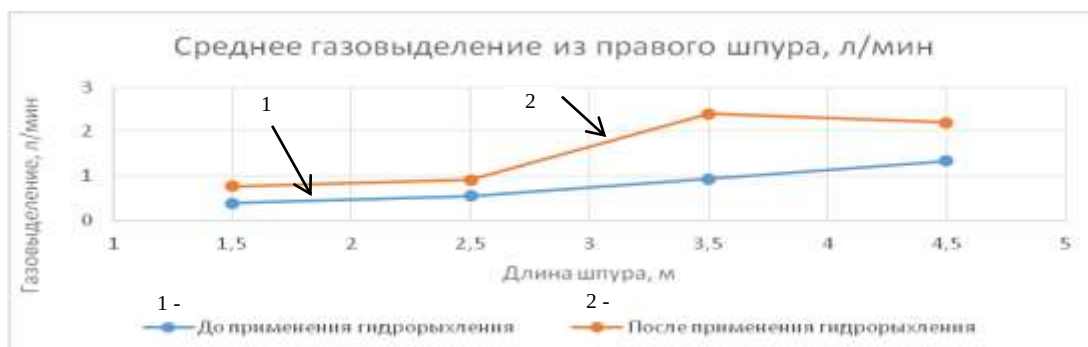
Рис. 4. Средние значения газовыделения из правого шпура на участке гидрорыхления и вне него
