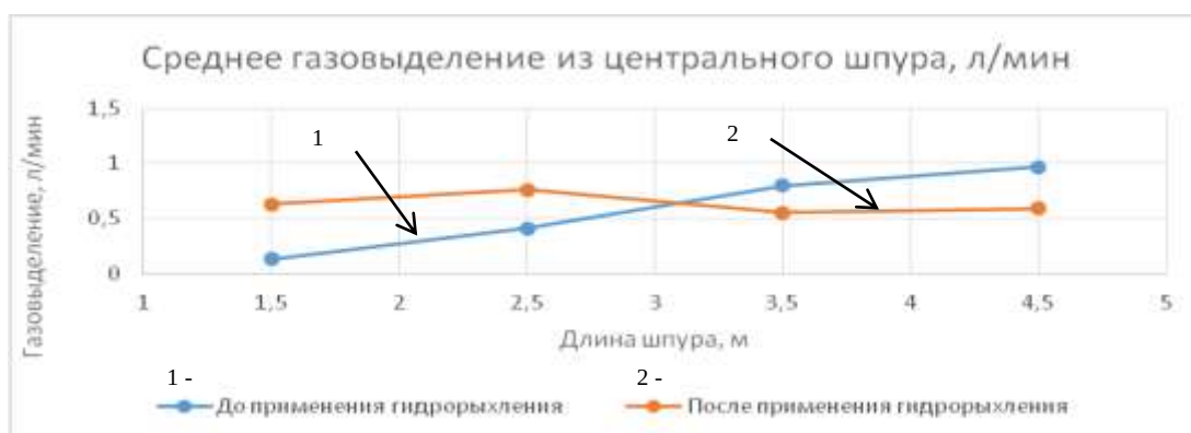
Рис. 3. Средние значения газовыделения из центрального шпура на участке гидрорыхления и вне него
