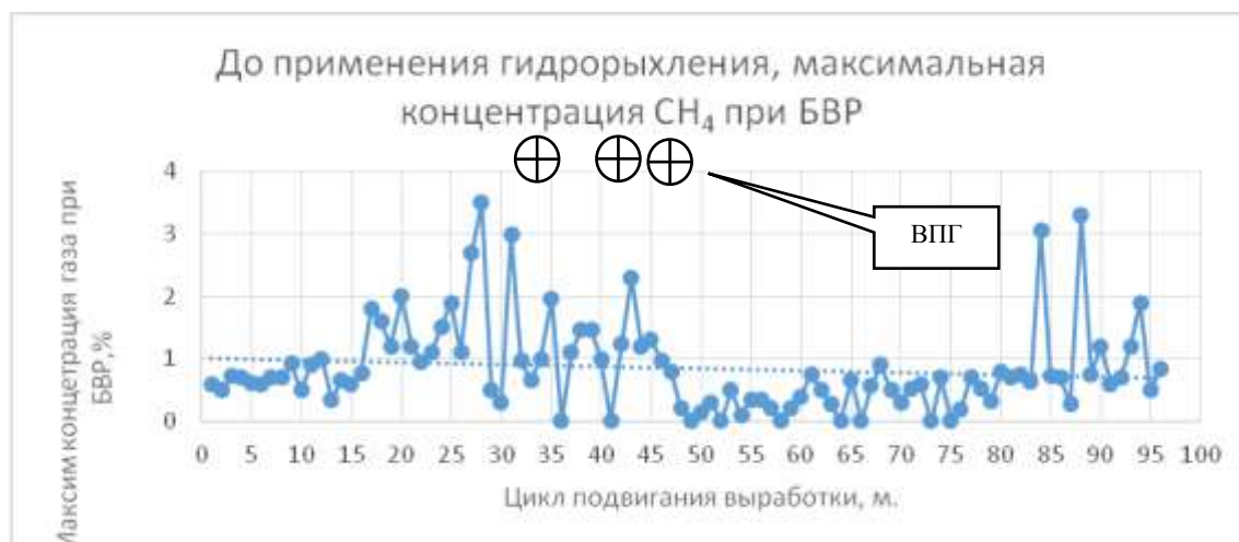
Рис. 8. Максимальная концентрация метана при БВР на участке транспортного штрека (север) без гидрорыхления
