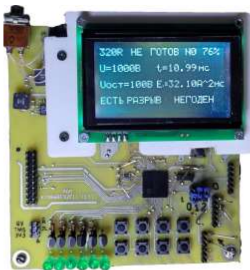
Рис. 7. Отладочная плата для микроконтроллера K1986BE92F11
