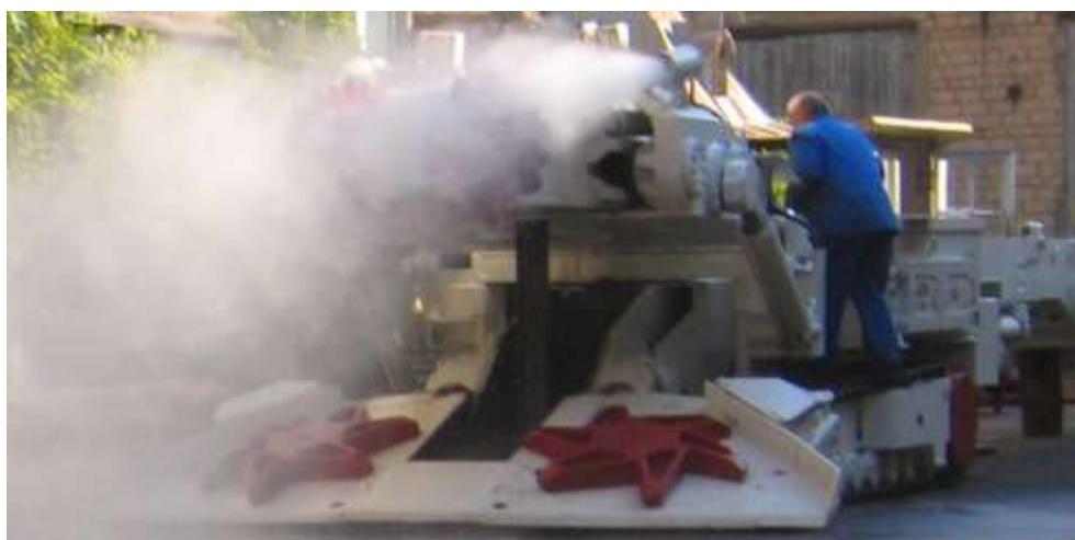
Рис. 3. Проходческий комбайн КПД с высоконапорной системой для внешнего орошения
