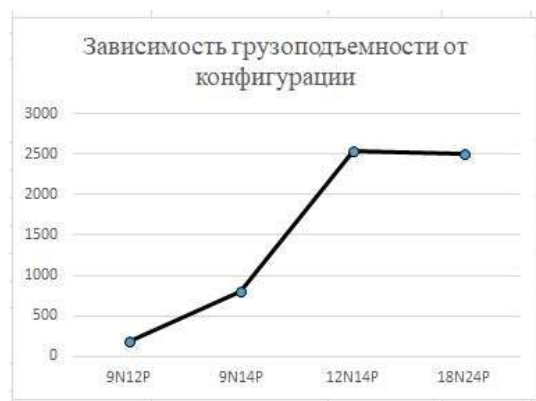
Рис. 2. Зависимость грузоподъемности мотора от конфигурации
