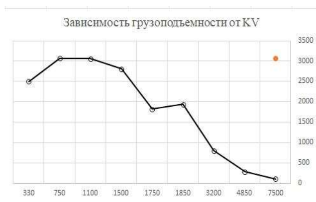
Рис. 4. Зависимость грузоподъемности мотора от KV
