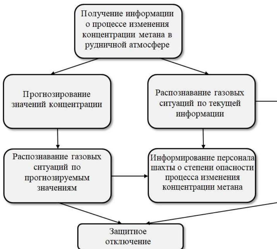
Рис. 4. Структурная схема обнаружения и прогнозирования газовых ситуаций
