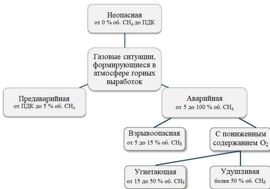
Рис. 3. Схема классификации газовых ситуаций для метановоздушных смесей
